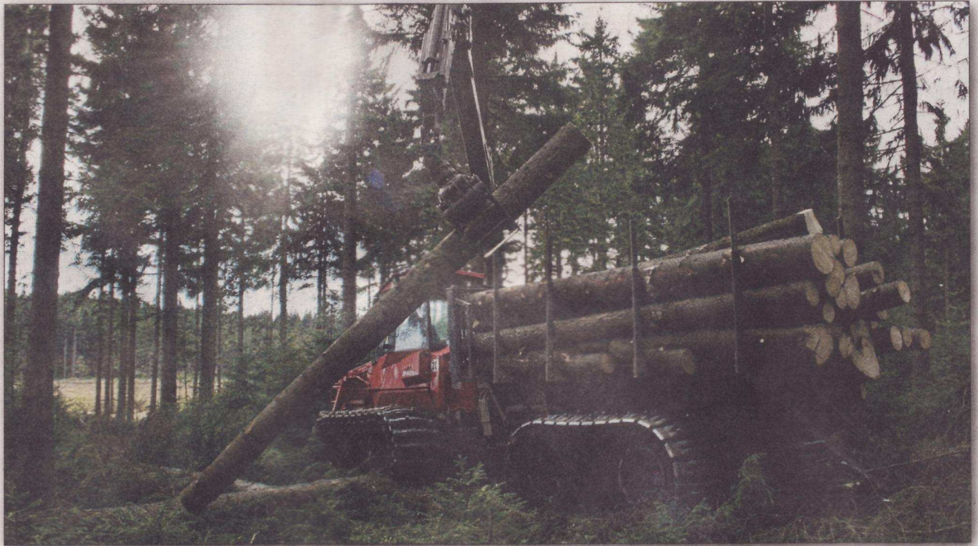
Spezial-Forwarder: Gewichtsmäßig abgespeckt und auf breiten Bändern am Rande des Moores unterwegs.
