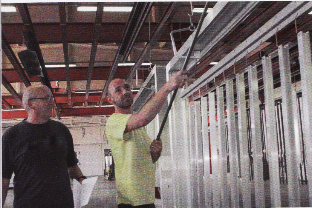
Balkonrahmen vor der Pulverbeschichtung - Abteilungsleiter Hartmut Hobfeld (links) und Nico Dörmer.
